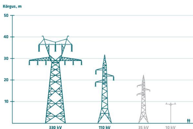
Joonis 55. Erineva pingeklassiga õhuliinide mastid. Allikas: Elering AS
