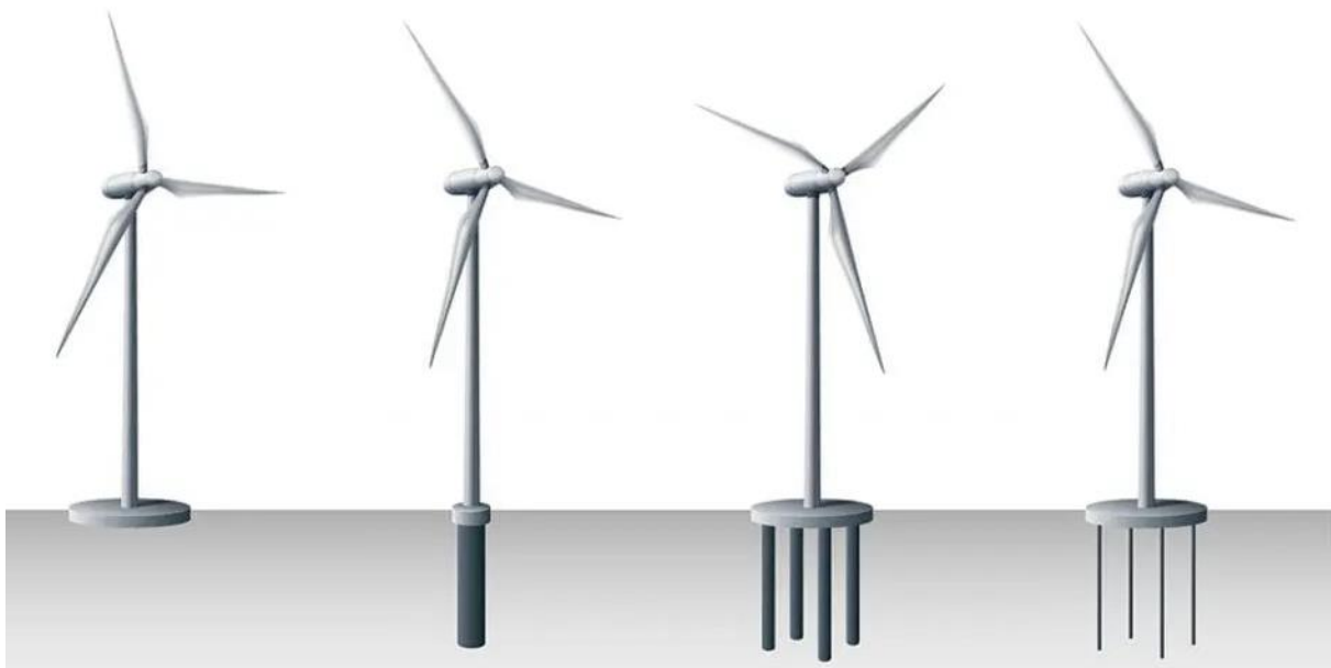
Joonis 3. Tuulikute vundamentide tüübid 8 .
